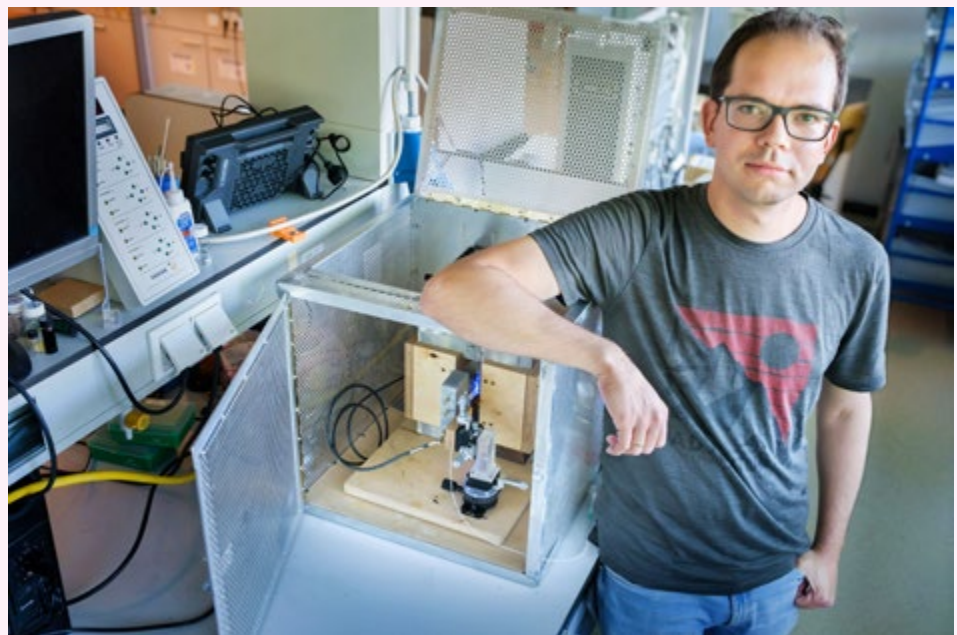
De NMR-meter staat in het lab in een metalen kooi om hem af te schermen tegen storende FM-radiozenders. Onderzoeker en ontwerper van het apparaat Sander Baas: 'De radiopuls werkt rond de 90 MHz; FM-radio zendt tussen 87-108 MHz uit. Vandaar die kooi van Faraday eromheen.' ♦ Foto Guy Ackermans
